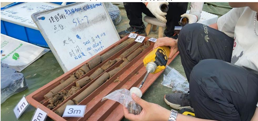
图 4.1-5 PID 现场检测
