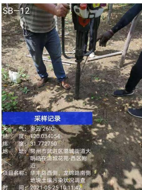
图4.1-2 本项目手持式采样机人工取土照片
