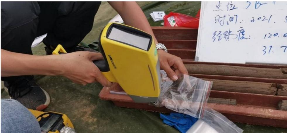
图 4.1-4 XRF 现场检测
